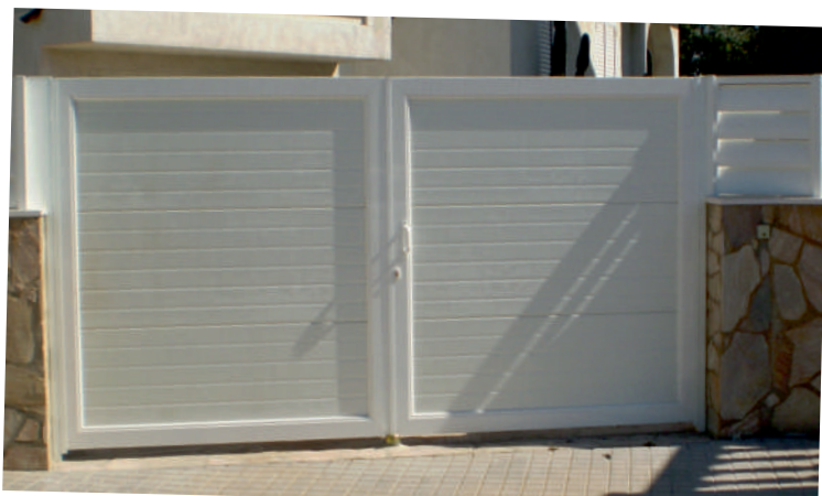
PUERTA BATIENTE DE DOS HOJAS, PERFILERIA ALUMINIO 110 X 80 ACABADO DE PANEL ACANALADO HORIZONTAL GOFRADO. LACADO TODO EL CONJUNTO EN BLANCO. (INTERIOR Y EXTERIOR)
