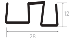
Junta carril hoja central AL115: 10€/mL SERIE MANZANARES
