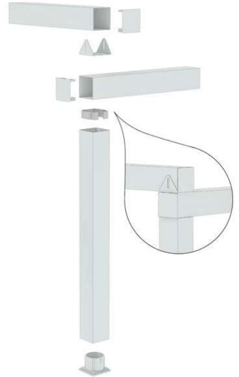
MONTAJE A DISTINTO NIVEL
