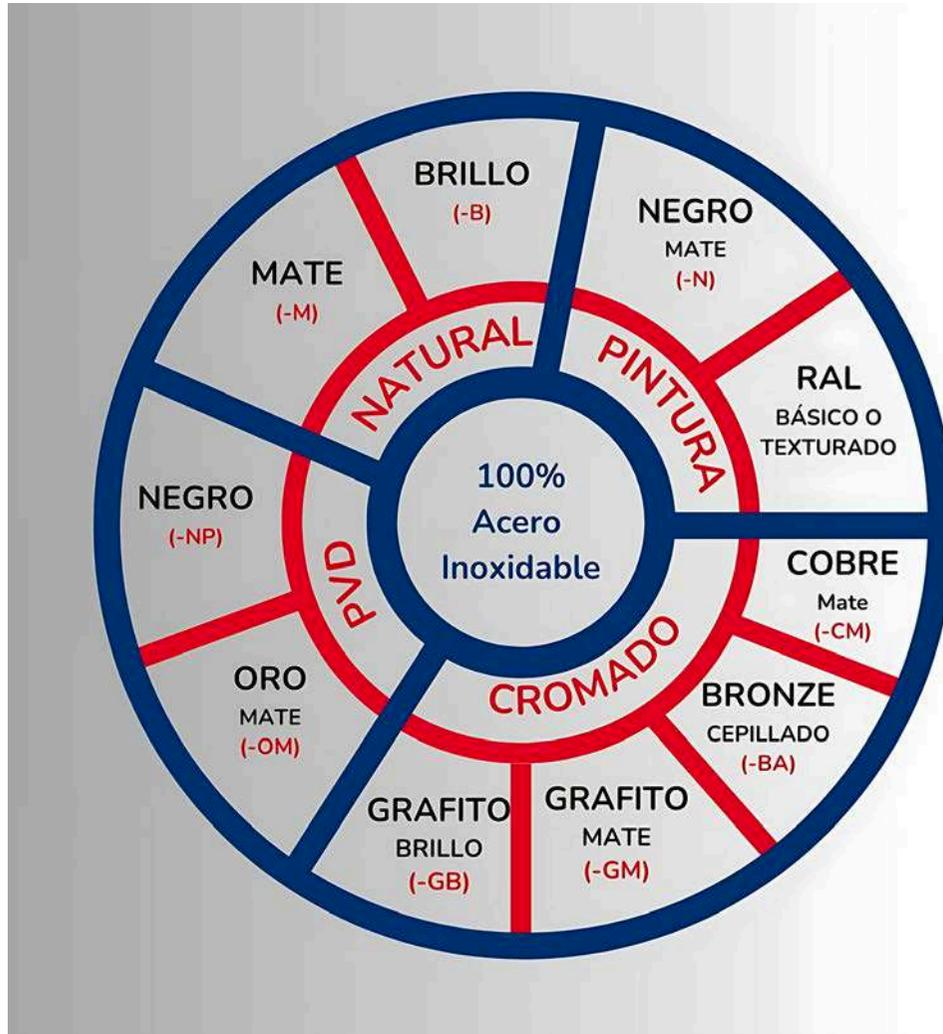
**PINTURA:** Recubrimiento con pintura en polvo sobre inoxidable, sin residuos peligrosos. Proceso en cabinas selladas (95 % se adhiere al metal o se recoge, se filtra y se reutiliza).
